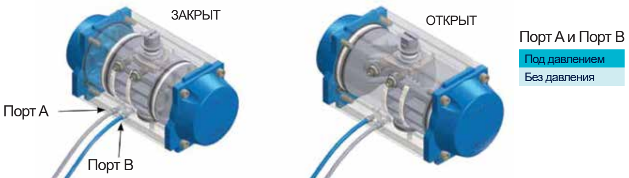
Рис 2. Приводы двойного действия
